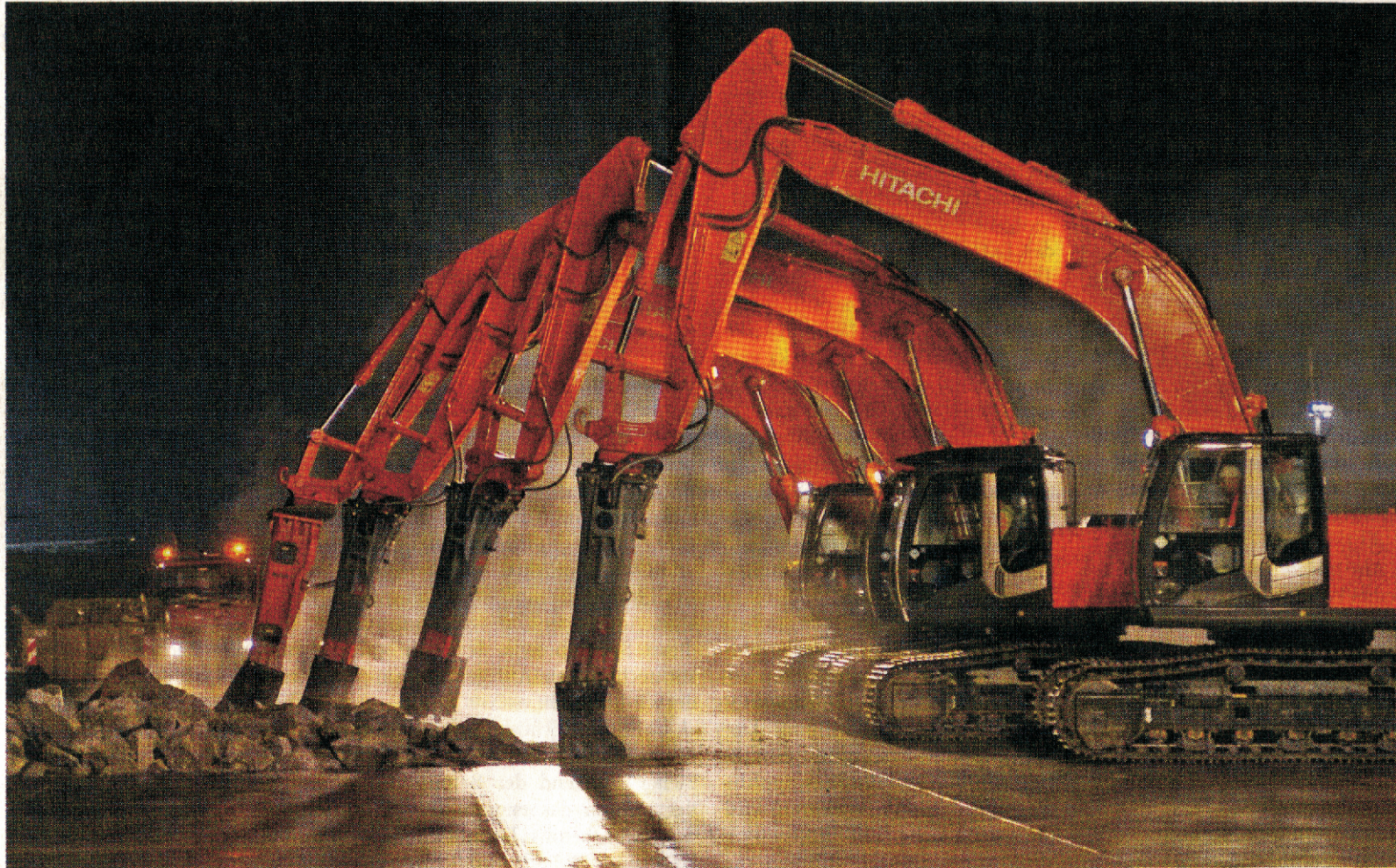
Der 4-Tonnen schwere B40 und die drei B30 Hämmer (3 t) liefen absolut zuverlässig und erforderten nicht einmal Wartungsarbeiten während des Einsatzes.
